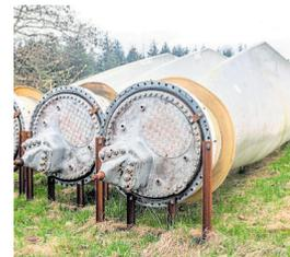
Abmontiert: So sehen abgebaute Rotorblätter am Boden aus.
